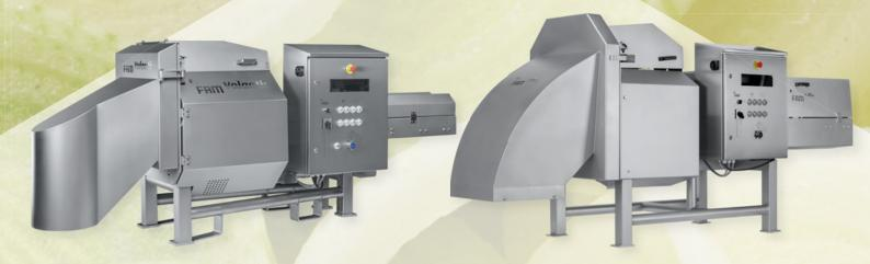
Слайсеры с V-образным подающим конвейером, предназначенные для точной поперечной нарезки различных продуктов удлиненной и продолговатой формы, таких как стручковая фасоль, морковь, кабачки
