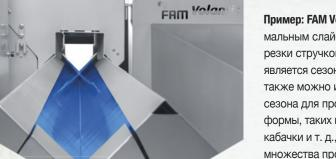
Пример: FAM Volantis является оптимальным слайсером для поперечной резки стручковой фасоли, которая является сезонным продуктом. Volantis также можно использовать вне этого сезона для продуктов удлиненной формы, таких как морковь, сельдерей, кабачки и т. д., так что это машина для множества продуктов.
