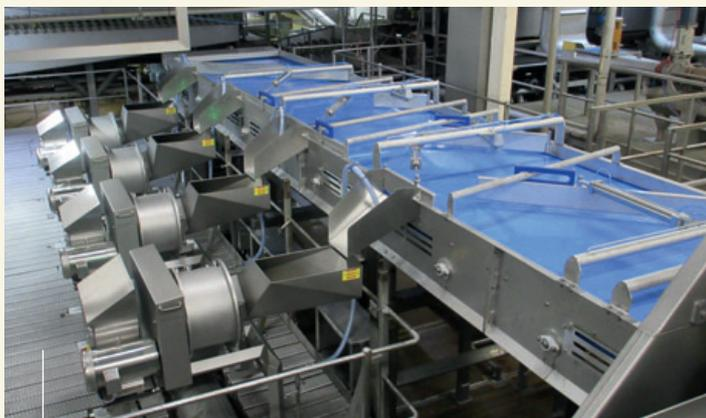
Машины Tridis 240P интегрированные в высокопроизводительную линию по производству картофеля фри.
